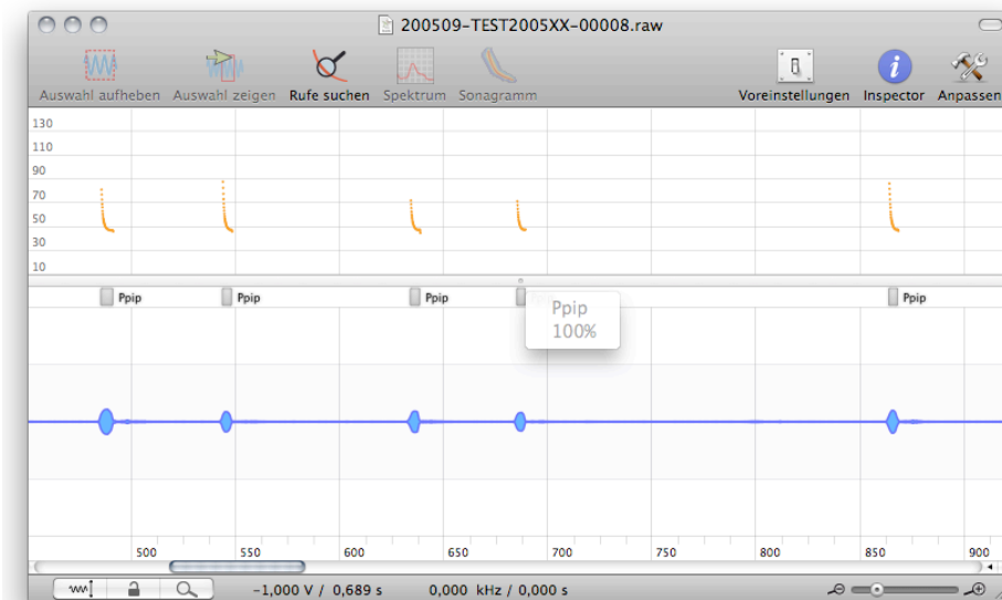
Abbildung 10: Darstellung der Ergebnisse je Ruf in bcAnalyze ab Version 1.07. Wenn vorhanden und aktiviert, werden die Rufergebnisse über dem Oszillogramm gezeigt. Durch Rechtsklick auf das graue Kästchen erhält man weitere Informationen.
