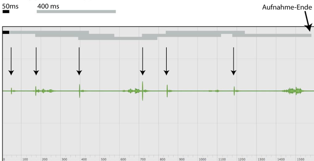
Die Grafik zeigt am Beispiel einer Sequenz die Pretrigger (50ms; nicht wählbar) sowie die Posttrigger Funktion des *batcorder*. Die Pfeile zeigen positive Trigger-Ereignisse (=Fledermaus-Rufe) an.
